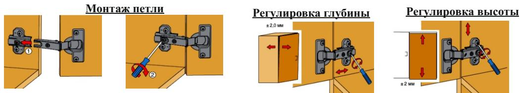
Боковая часть петли вводится под предварительно смонтированный винт монтажной планки и задвигается от себя.
