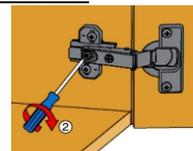
По завершении регулировки глубины двери затягивается винт.
