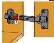
Боковая часть петли шлицем вводится под предварительно смонтированный винт монтажной планки и задвигается от себя.
