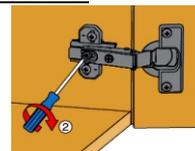
По завершении регулировки глубины двери затягивается винт.
