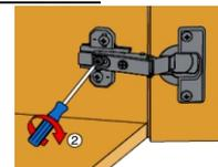
По завершении регулировки глубины двери затягивается винт.
