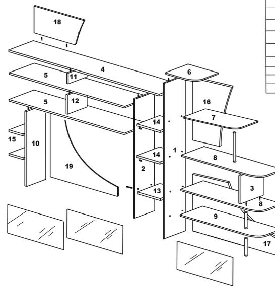
Гвозди 2\*25 используются для крепления ДВП, саморезами 4\*16 крепятся петли. Если несколько модулей устанавливаются рядом, их необходимо стянуть между собой межсекционными стяжками 25 мм, просверлив самостоятельно отверстия диаметром 5 мм в произвольных местах. К нижней крышке крепим опоры предварительно просверлив отверстия, согласно схеме присадки.
