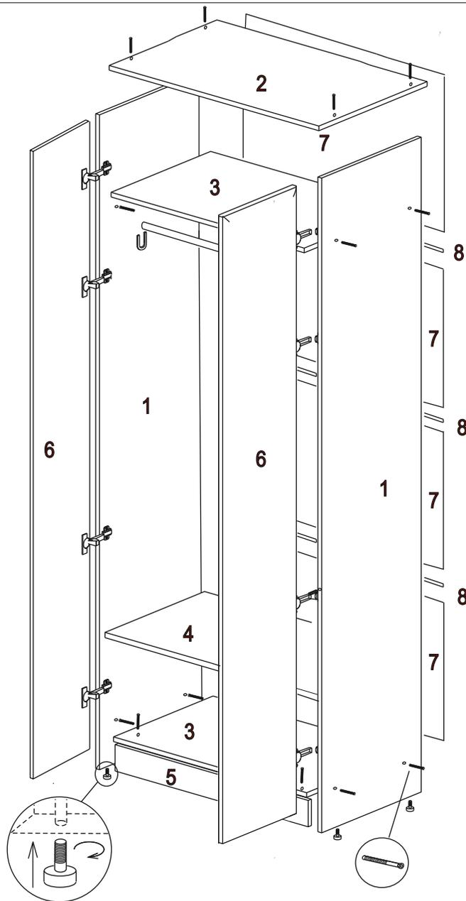
Гвозди 2\*25 используются для крепления ДВП, саморезами 4\*16 крепятся петли. Если несколько модулей устанавливаются рядом, их необходимо стянуть между собой межсекционными стяжками 25 мм, просверлив самостоятельно отверстия диаметром 5 мм в произвольных местах. К нижней крышке крепим опоры предварительно просверлив отверстия, согласно схеме присадки.
