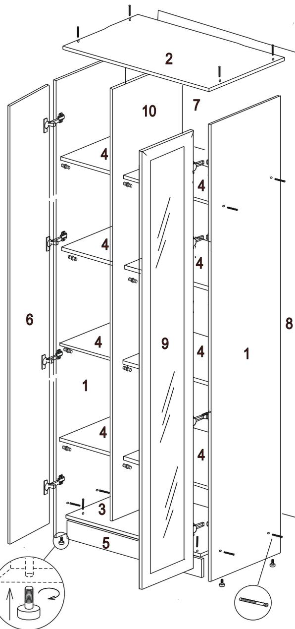
Гвозди 2\*25 используются для крепления ДВП, саморезами 4\*16 крепятся петли. Если несколько модулей устанавливаются рядом, их необходимо стянуть между собой межсекционными стяжками 25 мм, просверлив самостоятельно отверстия диаметром 5 мм в произвольных местах. К нижней крышке крепим опоры предварительно просверлив отверстия, согласно схеме присадки.
