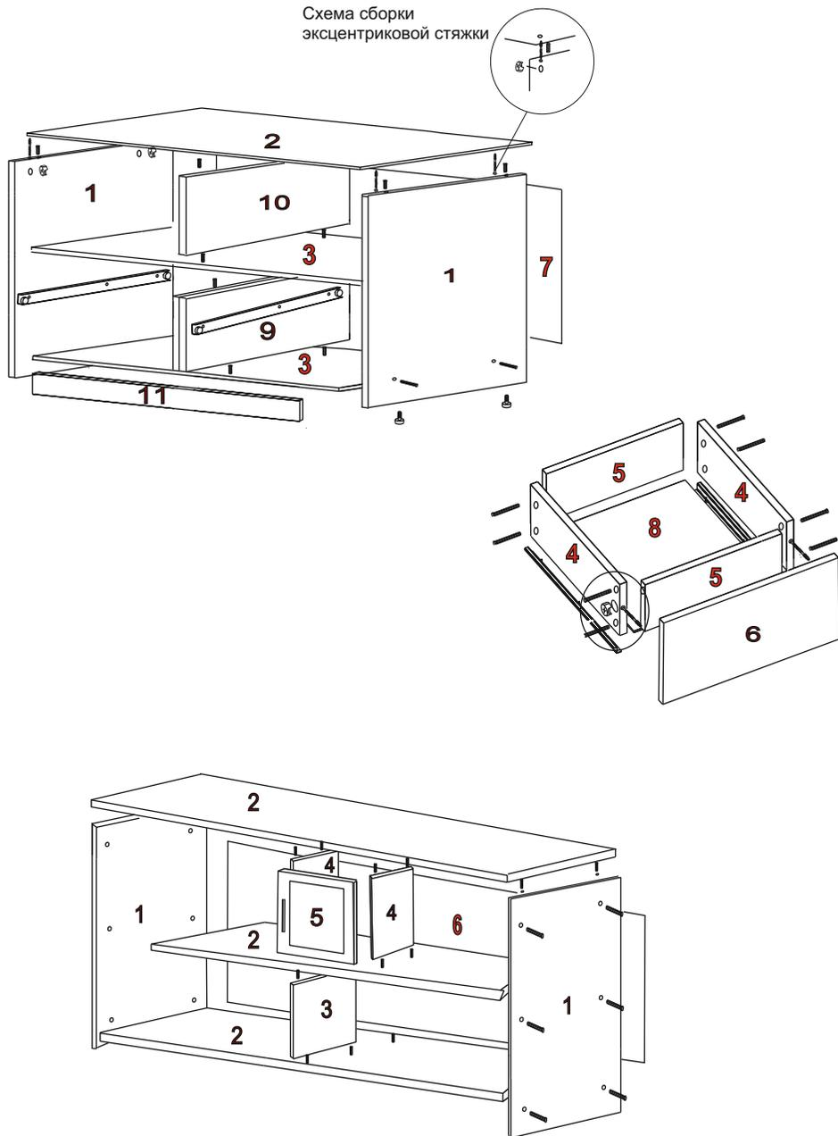
Гвозди 2\*25 используются для крепления ДВП , саморезами 4\*16 крепятся петли. . Если несколько модулей устанавливаются рядом, их необходимо стянуть между собой межсекционными стяжками 25 мм, просверлив самостоятельно отверстия диаметром 5 мм в произвольных местах. К нижней крышке крепим опоры предварительно просверлив отверстия, согласно схеме присадки.
