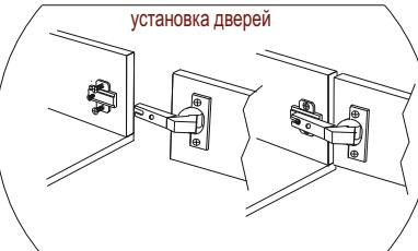
Гвозди 2\*25 используются для крепления ДВП и дна ящика, саморезами 3,5\*16 крепятся петли и направляющие ящиков, шурупами 3\*25-навесы. Стяжка 15 мм используется для установки штангодержателей.
