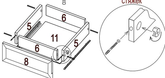
Гвозди 2\*25 используются для крепления ДВП и дна ящика, саморезами 3,5\*16 крепятся петли и направляющие ящиков, шурупами 3\*25-навесы. Стяжка 15 мм используется для установки штангодержателей.
