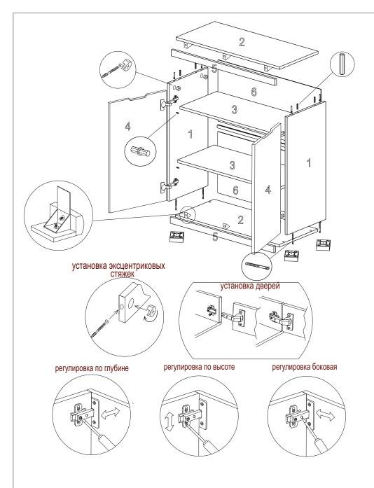
Гвозди 2\*25 используются для крепления ДВП и дна ящика, саморезами 3.5\*16 крепятся петли и направляющие ящиков.
